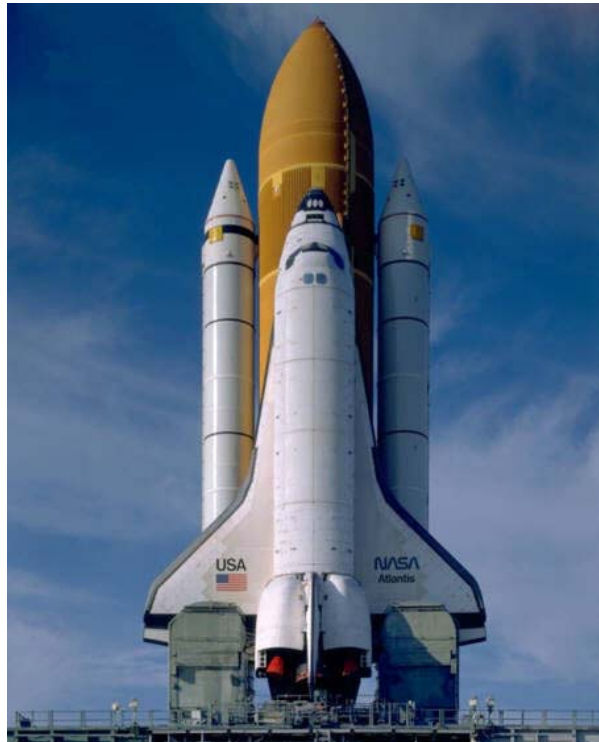
Figura 9 - Questa immagine mostra chiaramente tutte le parti dello Space Shuttle descritte nel testo. Al centro troviamo l'orbiter. Ai lati vediamo i due booster, mentre al centro, dietro, l'enorme serbatoio esterno, color arancione.
