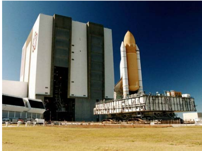
Figura 12 - Ecco lo Space Shuttle che esce dal VAB sopra l'enorme cingolato.
