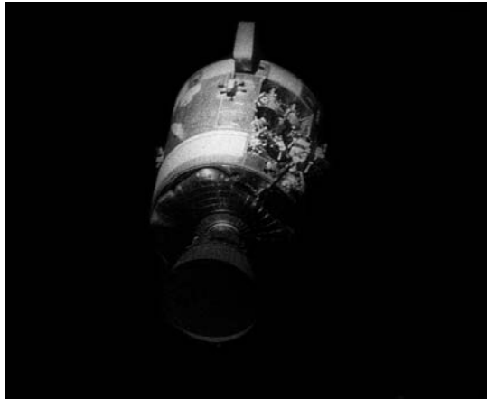
Figura 5 - La famosa immagine che mostra il modulo di servizio dell'Apollo 13 semi-distrutto (fianco destro) dall'esplosione. La foto è stata presa dal modulo di comando dopo il distacco. Copyright © NASA
