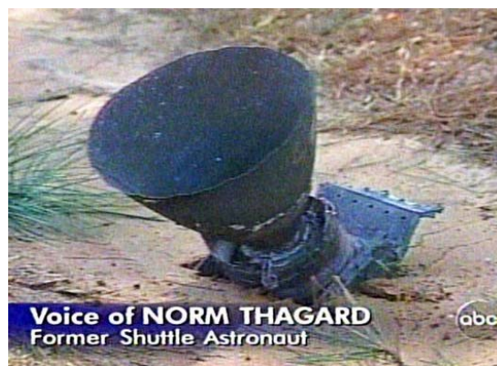
Figura 20 - Un detrito del Columbia. E' probabilmente l'ugello di un motore OMS.
