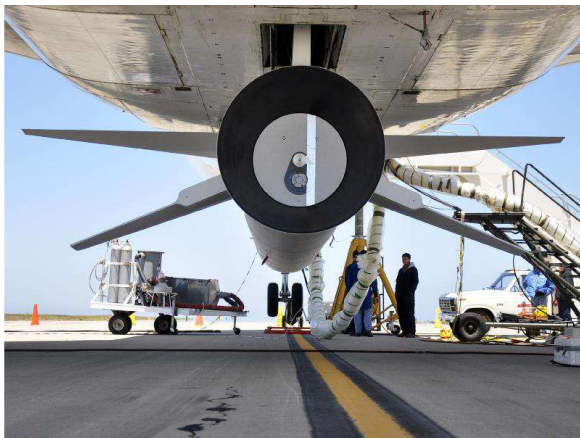
A sinistra il razzo Pegasus montato sotto l'aereo M-1011 di Orbital Sciences alla base Vandenberg, in California; a destra una ripresa della fase iniziale del suo volo verso la quota orbitale.
