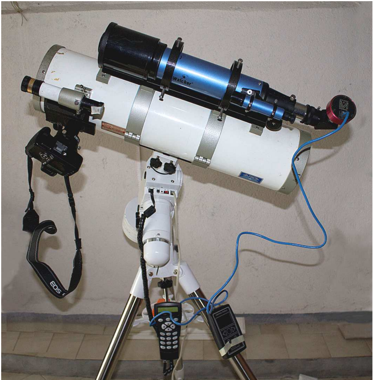
Figura 8. – Setup per riprese di cielo profondo: montatura equatoriale Sky-Watcher HEQ5 SynScan con GO-TO; telescopio principale Newton D:150mm, F:750mm; telescopio guida rifrattore D:70, F:500 con autoguidera LVI SmartGuider.
