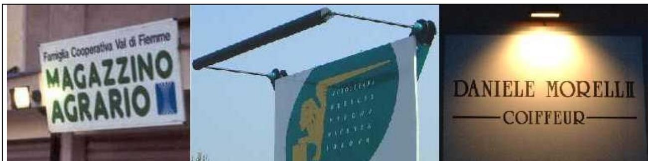
Fig.15 - Tre modi per illuminare le insegne. Nel primo (illuminazione laterale - foto a sinistra) si è evitato di illuminare dal basso ma come risultato ancora metà della luce viene comunque dispersa verso l'alto. Nel secondo, benchè le lampade siano schermate dall'armatura che si intravede nella foto parte della luce esce oltre il bordo superiore del pannello stradale. Ed infine nel terzo impianto senza dubbio insegna di esercizio conforme alla LR17/00 (illuminazione dall'alto verso il basso).
