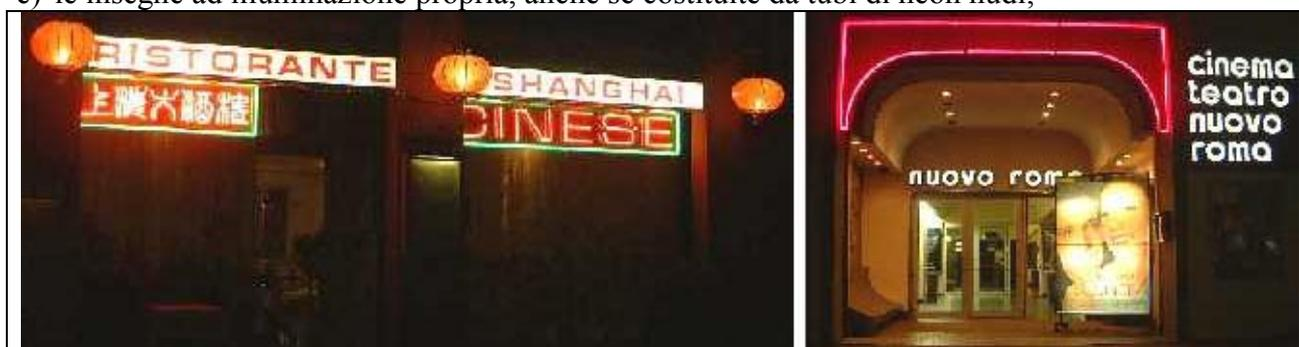
*Fig.22 – Alcuni tipi di insegne derogate dalla legge e per le quali la legge richiede solamente, ma solo nelle fasce di rispetto, lo spegnimento dopo le 23 o all'orario di chiusura dell'esercizio. Si vedono: lettere scatolate con illuminazione propria (la scritta cinema), neon nudi (decorazione ingresso al cinema e scritta in cinese), o pannelli ad illuminazione interna (le scritte ristorante e la locandina del cinema).*
