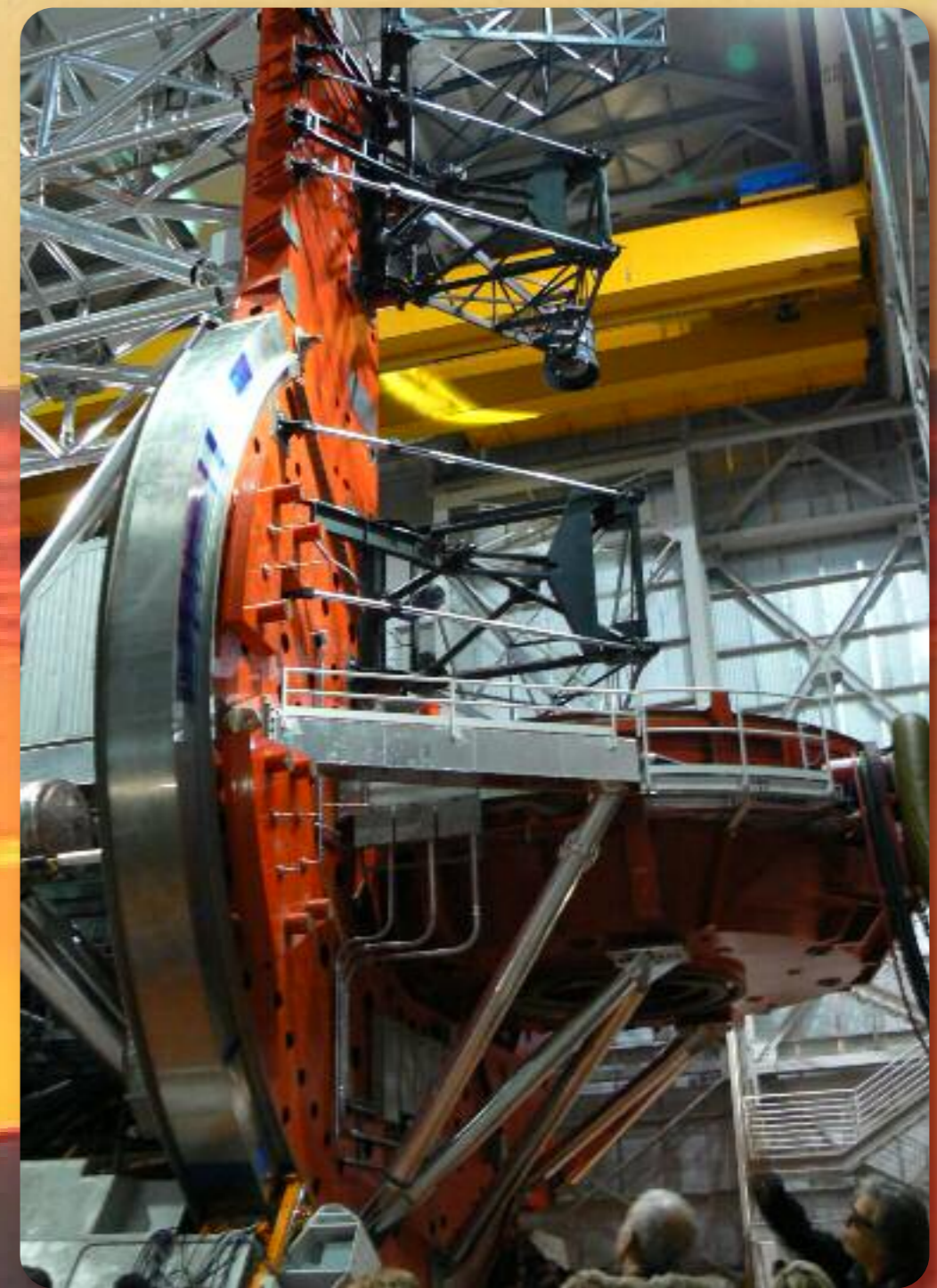
Il meccanismo per portare gli specchi in posizione verticale
